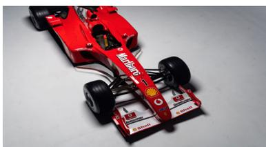
nava il meglio del modello F2001, con il suo collaudato motore Tipo 050 V-10 progettato da Gilles Simon e il cambio sequenziale elettroidraulico a sette marce, con diverse innovazioni dell'imminente F2002. Un nuovo pacchetto aerodinamico ha aumentato considerevolmente la deportanza, mentre la trasmissione presentava diversi aggiornamenti presi in prestito dal motore Tipo 051 ancora in fase di sviluppo. Mentre Schu-
