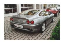
i caratteristici doppi fari circolari della Ferrari. Per la tecnica motore della 575M, essa ha un motore più grande con una cilindrata di 5,75 l (5.748 cc) invece di 5,5 l, da cui il nuovo nome, e la potenza massima a 515 CV. Mentre a trasmetterla a terra fu un nuovo cambio manuale "F1" a sei marce, una tecnologia che la Ferrari aveva sviluppato in Formula 1. Nel 2005, la 575M era dis-
