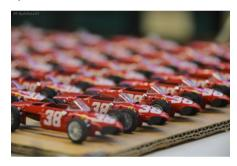
plastico viene acquistato in granuli di colore neutro, in seguito vengono aggiunti quelli colorati in base alle tonalita' che si desidera ottenere. Questi vengono usati per la realizzazione degli interni e le gomme, che sono stampati con presse ad inizione di basso tonnellaggio ma di grande velocità.
